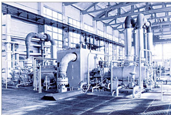
Рис. 2. Центробежный компрессорный агрегат синтез-газа 433ГЦ2-143/25-321 ПМ
