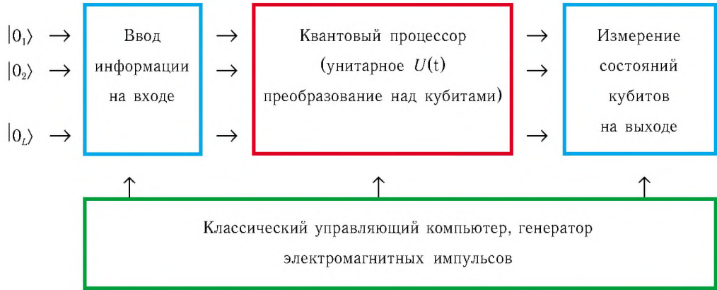
Рис. 4. Схематическая структура квантового компьютера
